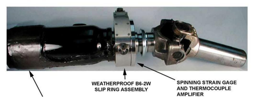
WEATHERPROOF COATINGS OVER STRAIN GAGE TORQUE BRIDGE
