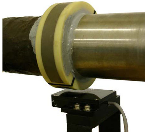
安装在风力涡轮机驱动轴上的 3.5 英寸分体式轴环式遥测仪， 配有“桨”式初级感应线圈。
