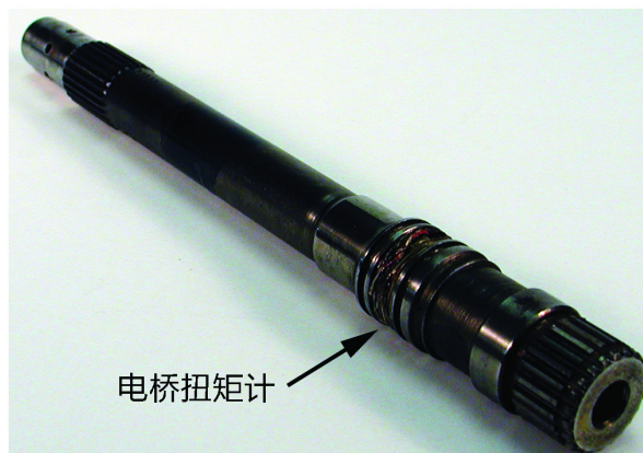
变速箱输入轴—— 计量与校准应变, 以测量扭矩
