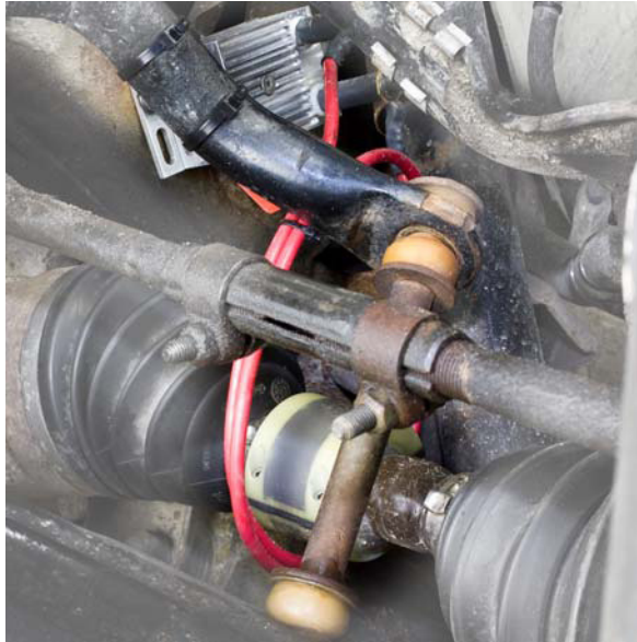
安装在汽车半轴上的 1.2 英寸分体式轴环， 配有双环初级感应线圈。
