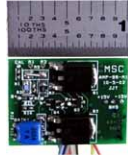
型号 AMP-SG1-M1 (单通道应变仪放大器)
