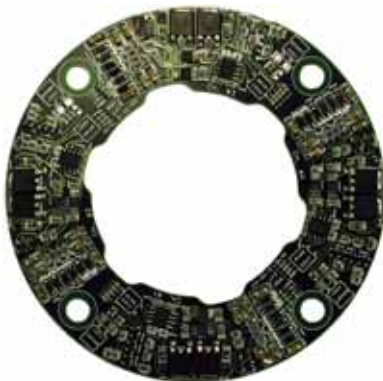
型号 AMP-SG4-R4 (四通道应变仪放大器)
